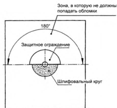
Рисунок 3 – Испытание защитных ограждений. Зона, в которую не должны попадать обломки
