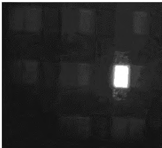
Рисунок 16 – Дефект субпикселя в ЖКИ, работающем на пропускание и отражение, в темноте
