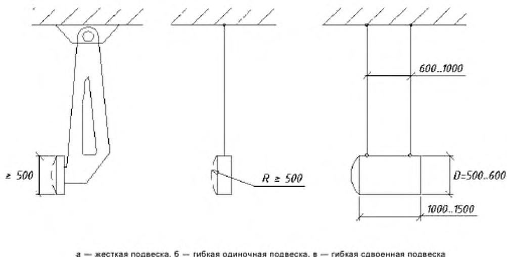
Рисунок 4 — Схемы закрепления маятника
