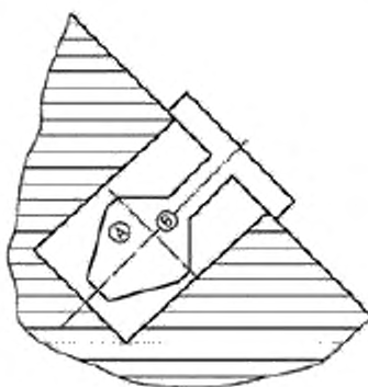
Рисунок Г.10 – Примеры размещения зоны А шаблона при испытаниях зазоров, вариант 1.
