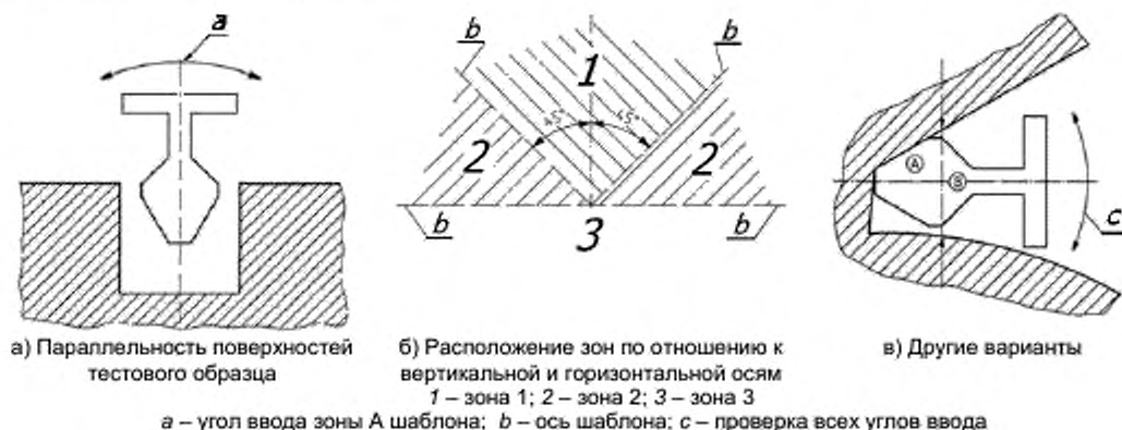
Рисунок Г.9 – Испытание зазоров с использованием зоны А шаблона
