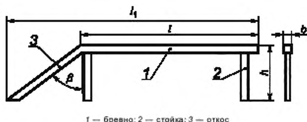
Рисунок 7 — Элементы конструкции бревна
