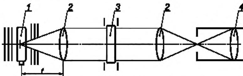
1 -- ИС; 2 -- конденсоры; 3 -- нейтральный светофильтр; 4 -- входной коллиматор спектрального прибора.
