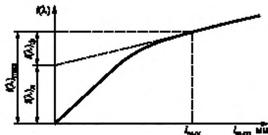
$i(\lambda)_л$  — доля фототока приемного устройства обусловленная излучением линии,  $i(\lambda)_ф$  — доля фототока приемного устройства обусловленная излучением фона в месте излучения линии при ширине выходной щели  $l_{вых}$
