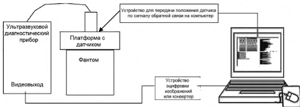
Рисунок А.1 – Пример оборудования для проведения измерений
