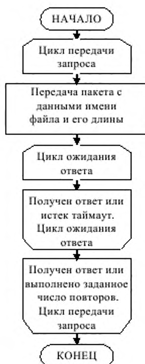
Рисунок 6 – Блок-схема алгоритма процесса запроса на передачу файла и ожидания ответа
