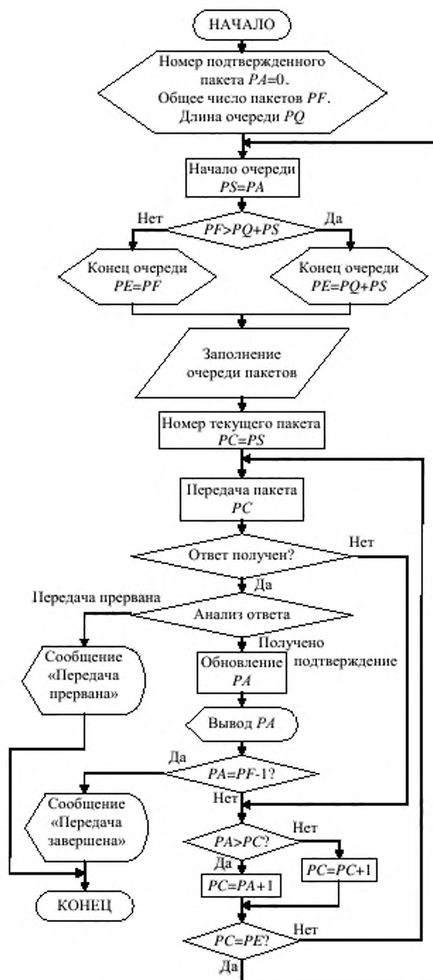
Рисунок 7 – Блок-схема алгоритма процесса передачи данных файла
