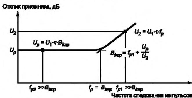
Рисунок E.7 — Расчет ширины импульсной полосы пропускания ИП
