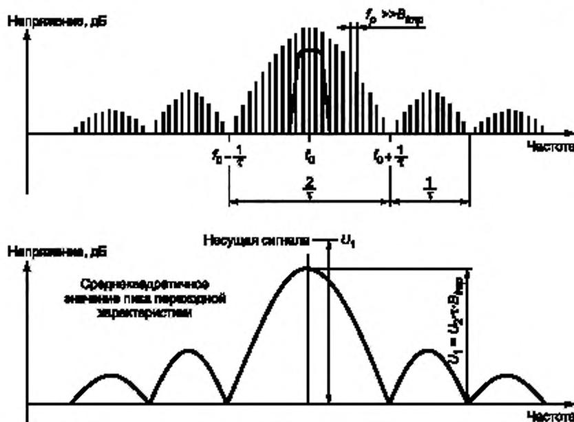
Рисунок E.6 — Фильтрация, когда значение  $B_{\text{имп}}$  намного больше частоты повторения импульсов
