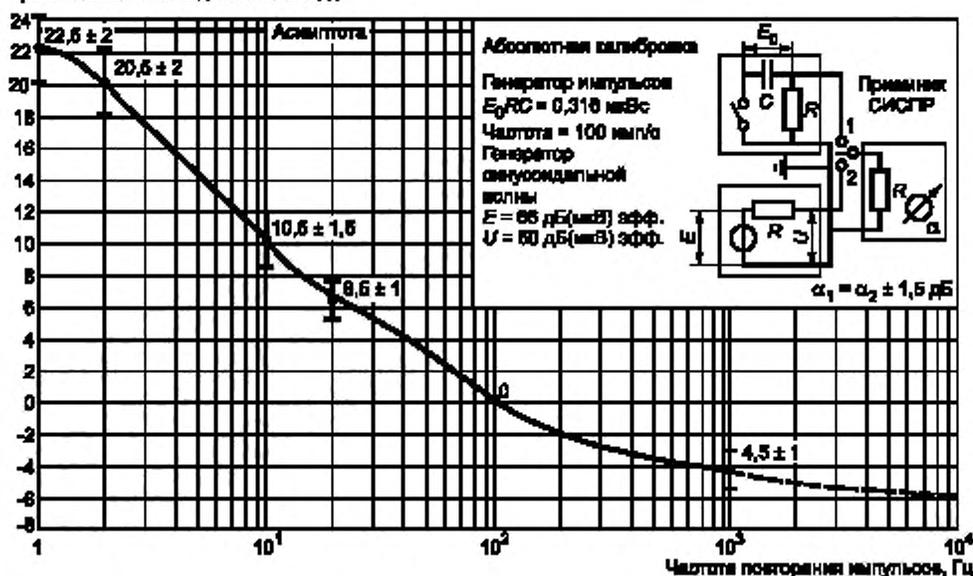
б) Импульсная характеристика ИП для полосы частот В (от 0,15 до 30 МГц) и допускаемые отклонения ее значений
