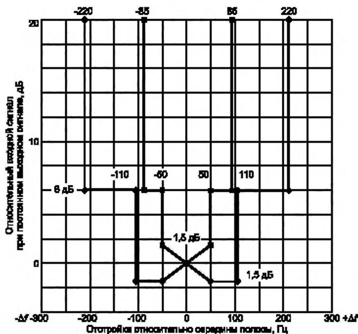
а) Пределы характеристики частотной избирательности ИП для полосы частот А (от 9 до 150 кГц)
