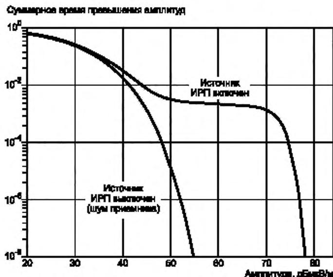
Рисунок G.3 — Пример функции распределения амплитуд ИРП
