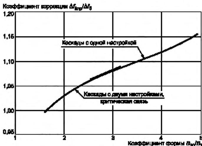
Рисунок Е.1 — Коэффициент коррекции для оценки отношения  $B_{изм}/B_0$  для других типов настраиваемых схем
