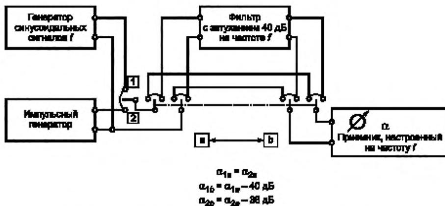
Рисунок 3 – Схема измерения ослабления продуктов интермодуляции
