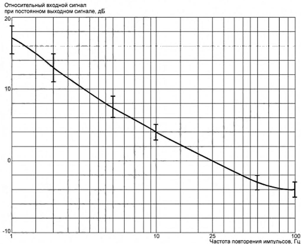
а) Импульсная характеристика ИП для полосы частот А (от 9 до 150 кГц) и допустимые отклонения ее значений
