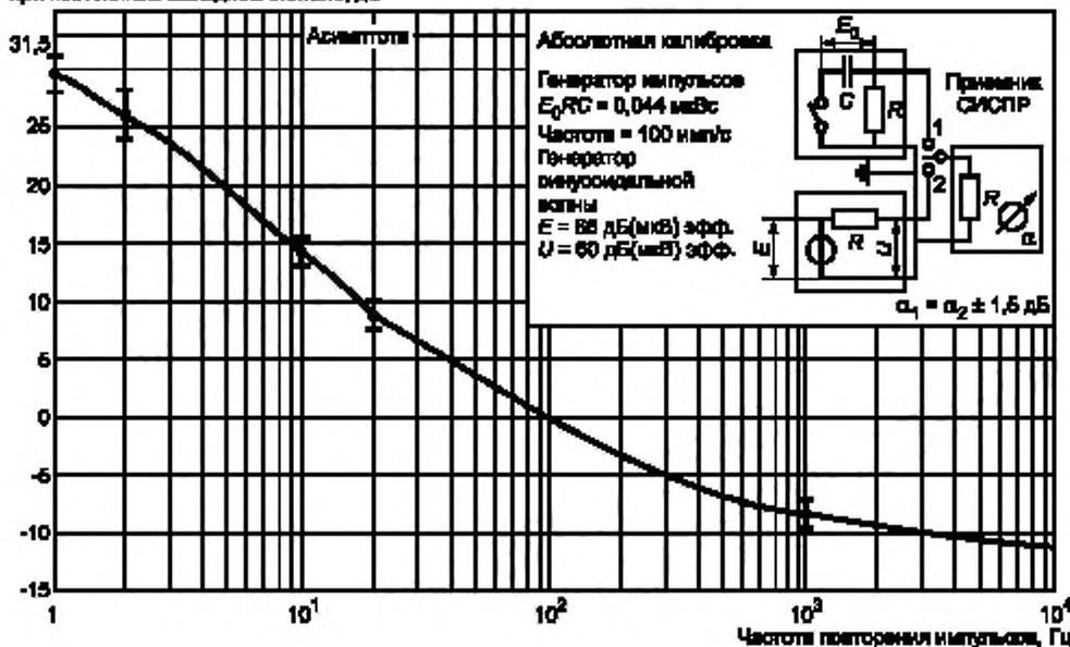
с) Импульсная характеристика ИП для полосы частот C/D (от 30 до 1000 МГц) и допускаемые отклонения ее значений
