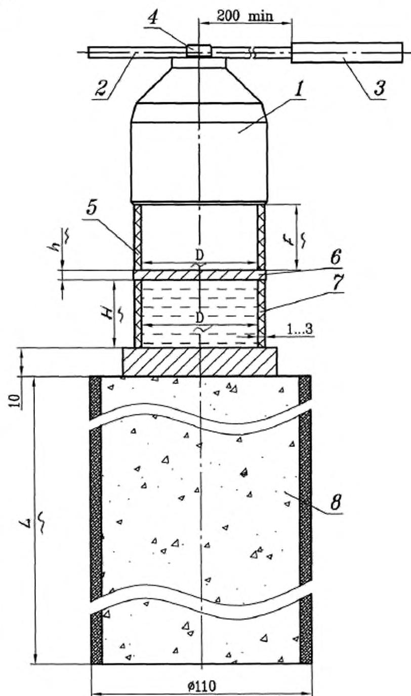
1 – КЗ; 2 – отрезок ДШ; 3 – электродетонатор; 4 – фиксатор (при необходимости); 5 – фокус-дистанционная втулка (пластик); 6 – стальная пластина (сталь Ст3-Ст20, квадрат 50х50); 7 – клиренс-втулка (пластик) с водой; 8 – МККБ
