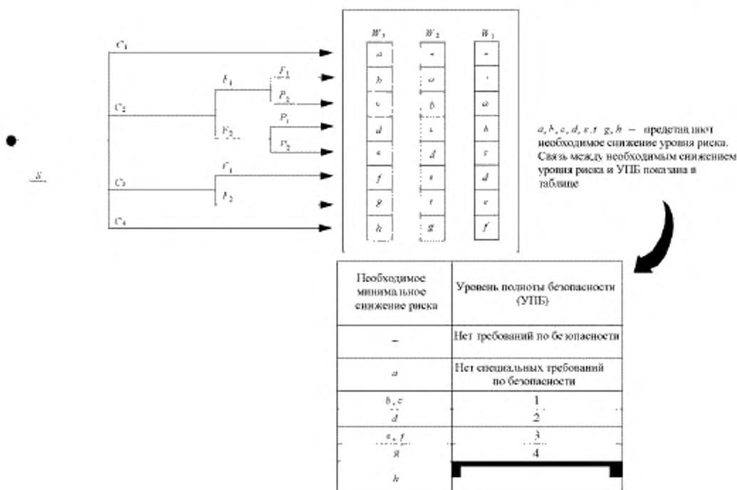
$S$  – начальная точка для оценки снижения риска;  $C$  – значимость параметра риска;  $F$  – параметр риска частоты и длительности экспозиции;  $P$  – параметр риска возможности избежать опасности;  $W$  – вероятность нежелательного происшествия;  $a, b, c, \dots, h$  – оценка требуемого снижения риска для ВКР лазера
