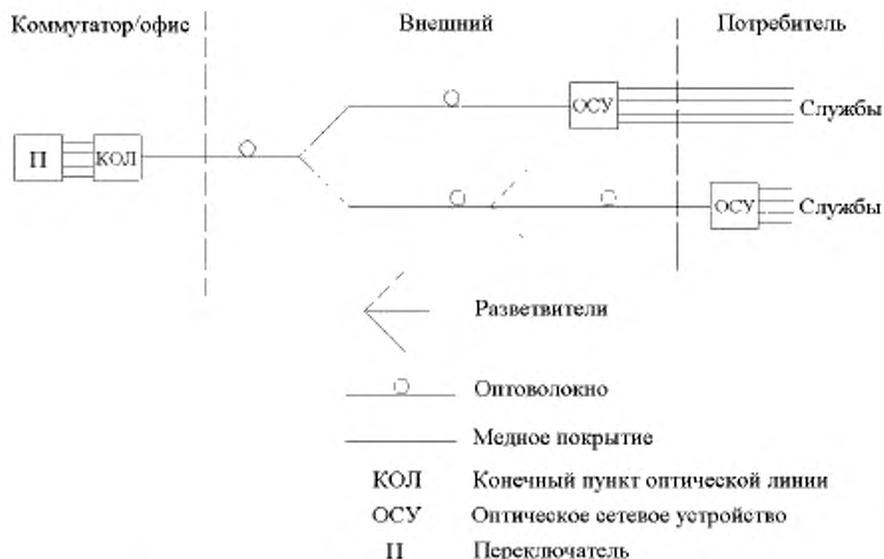
Рисунок D.1 – ПОС (пассивная оптическая сеть) – базовая система
