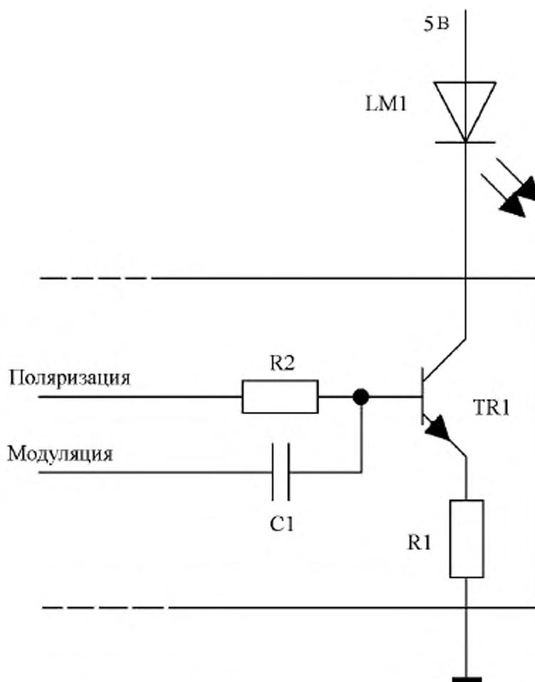
Рисунок D.2 – Задающий контур обычного лазера
