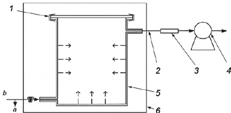
1 – зажим; 2 – линия передачи (обеспечивающая поддержание температуры на уровне от 200 °С до 220 °С или более на протяжении всего испытания); 3 – сорбционная трубка (для отбора проб СЛОС, десорбированных с внутренних стенок микрокамеры при термической десорбции); 4 – лобовитель расхода; 5 – микрокамера; 6 – устройство нагрева микрокамеры (от 200 °С до 220 °С); а – линия сброса избытка газа; б – линия подачи инертного газа ( $He$  или  $N_2$ )
