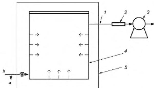
1 – передаточная линия; 2 – сорбционная трубка; 3 – побудитель расхода; 4 – микрокамера; 5 – устройство нагрева камеры; a – линия сброса избытка инертного газа; b – линия подачи инертного газа
