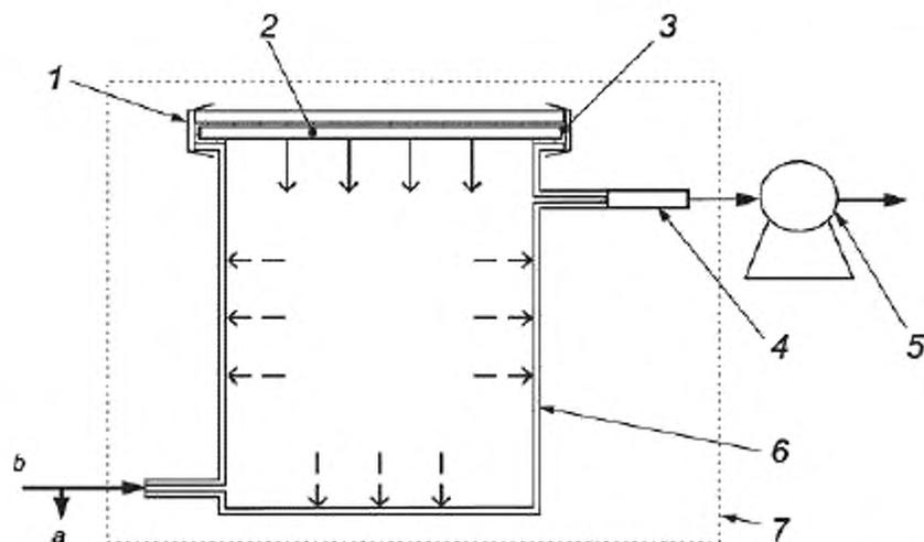
1 – зажим; 2 – испытываемый образец; 3 – изолирующий материал; 4 – сорбционная трубка (для отбора проб воздуха на выходе из камеры); 5 – лобовитель расхода; 6 – микрокамера; 7 – термостат; а – линия сброса избытка газа; б – линия подачи чистого воздуха с установленной влажностью (относительная влажность  $(50 \pm 5) \%$ )
