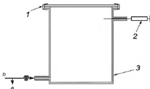
1 – зажим; 2 – микрошприц; 3 – микрокамера; а – линия сброса избытка газа;
