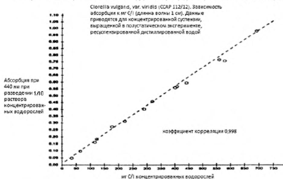
Рисунок В.3 Номограмма зависимости содержания углерода. Зависимость абсорбции от мг С/л
