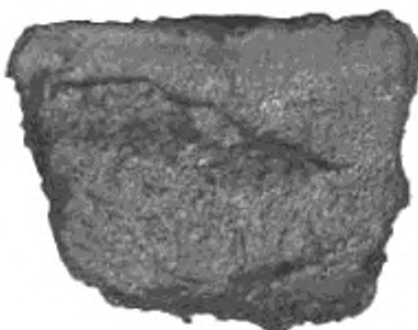
Рисунок Б.1 — Излом мелкозернистый, матовый
