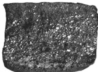
Рисунок Б.12 — Излом среднезернистый, кристаллический
