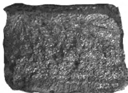
Рисунок Б.11 — Излом мелкозернистый, кристаллический
