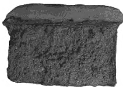
Рисунок Б.1 — Излом мелкозернистый, матовый
