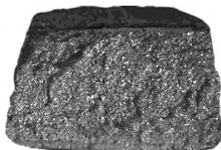
Рисунок Б.10 — Излом мелкозернистый, кристаллический
