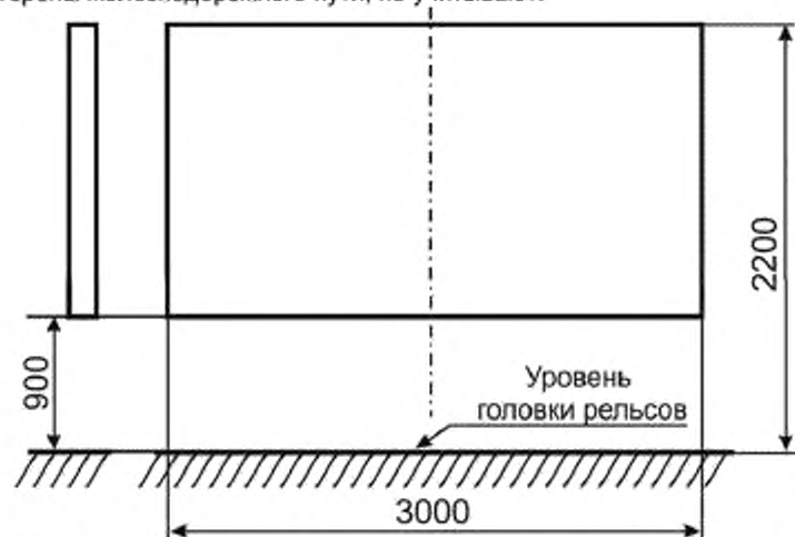
Рисунок 1 – Размеры препятствия при аварийном столкновении по сценарию 1
