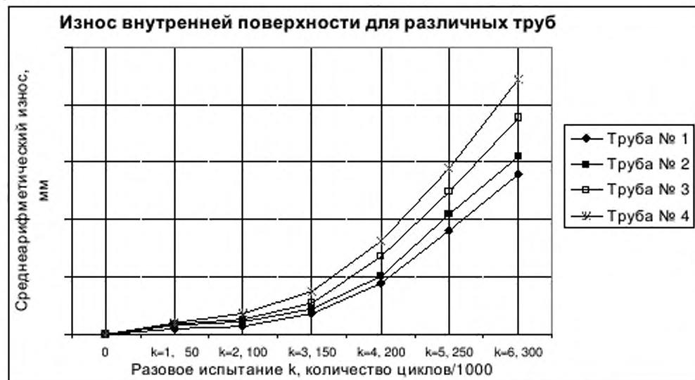
Рисунок 4 – Зависимость износа от количества испытательных циклов
