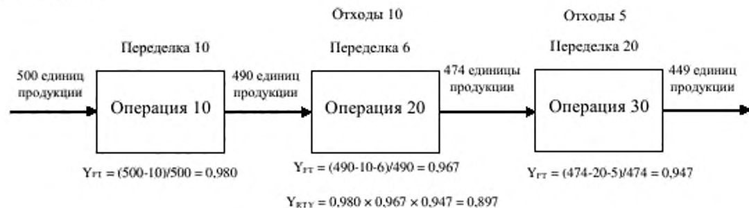
Рисунок 3 – Пример вычисления вероятности штучного сквозного выхода
