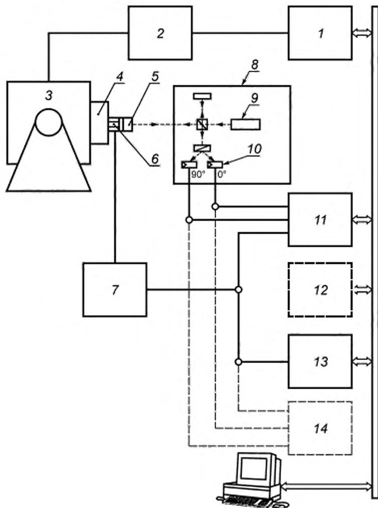
1 — генератор частоты (3.2); 2 — усилитель мощности (3.3); 3 — вибростенд (3.3); 4 — подвижная система вибростенда;
