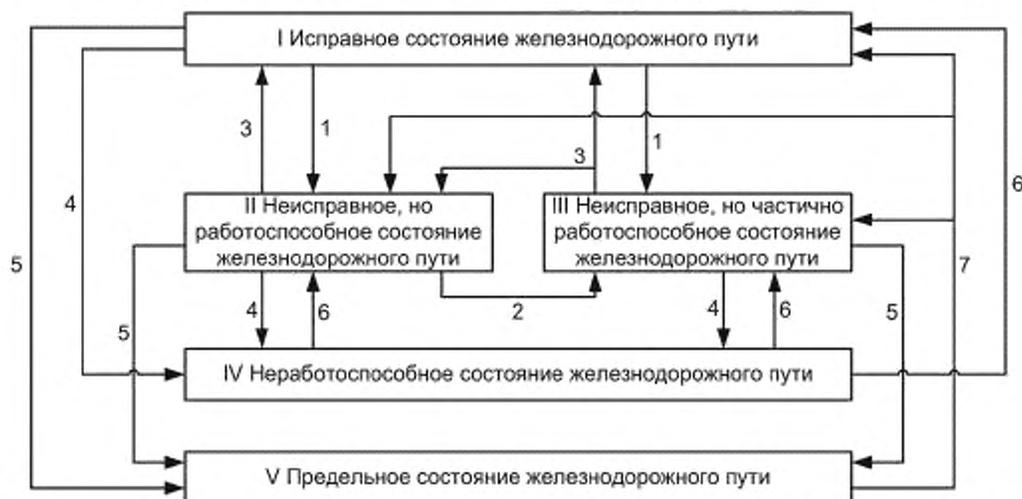
1 – накопление повреждений; 2 – частичный отказ железнодорожного пути; 3 – текущее содержание пути; 4 – полный отказ железнодорожного пути; 5 – переход железнодорожного пути в предельное состояние; 6 – восстановление работоспособного состояния железнодорожного пути; 7 – реконструкция (модернизация), капитальный ремонт железнодорожного пути.
