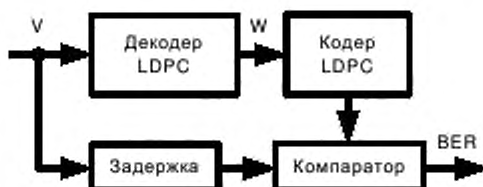
Рисунок 6 – Измерение BER до канального декодера LDPC
