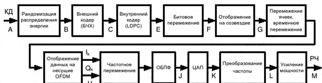
Рисунок 1 – Функциональная схема передающей части системы РАВИС (передатчик)
