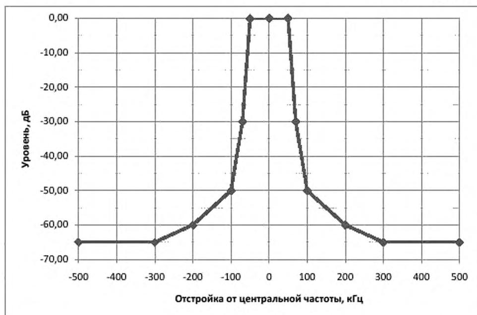
Рисунок 1 – Маска огибающей внеполосных радиколебаний для ширины полосы частот 100 кГц
