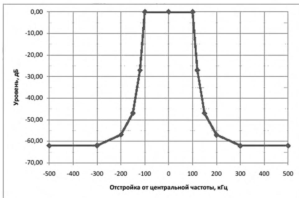
Рисунок 2 – Маска огибающей внеполосных радиколебаний для ширины полосы частот 200 кГц
