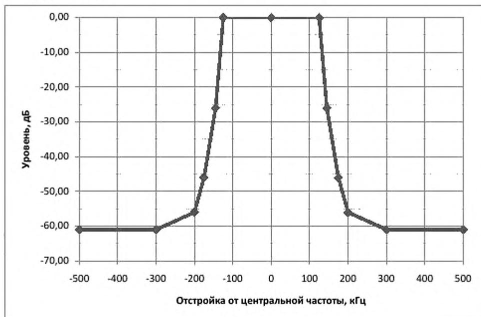
Рисунок 3 – Маска огибающей внеполосных радиоколечаний для ширины полосы частот 250 кГц
