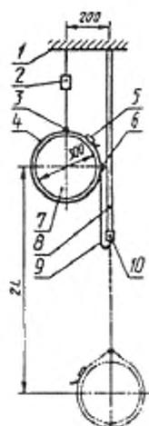
1 – жесткая опора; 2 – сбрасыватель; 3 – соединительное устройство; 4 – безлямочный пояс;
