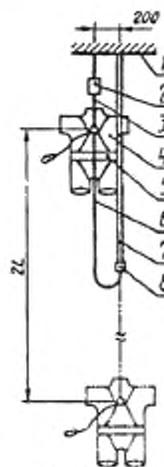
1 – жесткая опора; 2 – сбрасыватель; 3 – соединительное устройство; 4 – манекен;
