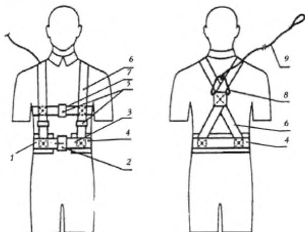
1 – ремень; 2 – пряжка со шпеньком; 3 – люверсы; 4 – кушак; 5 – пряжка наплечной и нагрудной лямки; 6 – наплечная лямка; 7 – нагрудная лямка; 8 – распределительное кольцо; 9 – веревка
