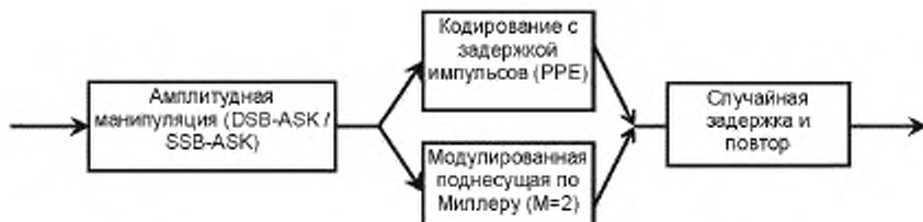
Рисунок 8 — Структура радиочастотной метки типа D
