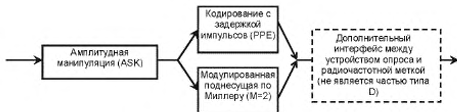
Рисунок 4 — Структура устройства опроса типа D
