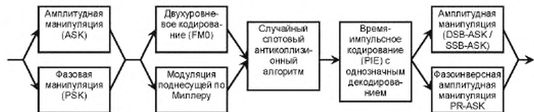
Рисунок 3 — Структура устройства опроса типа С
