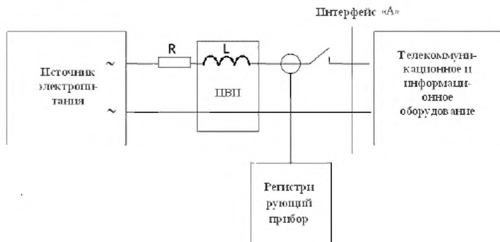
Рисунок 3 - Схема измерения импульсного тока для интерфейса переменного тока
