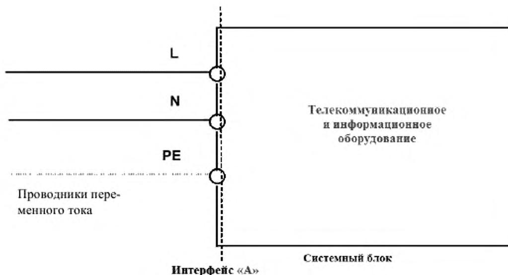
Рисунок 1 - Определение интерфейса «А»
