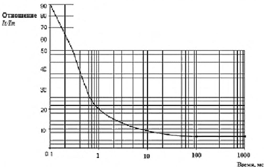
Рисунок 2 - Максимальный пусковой ток для телекоммуникационного оборудования
