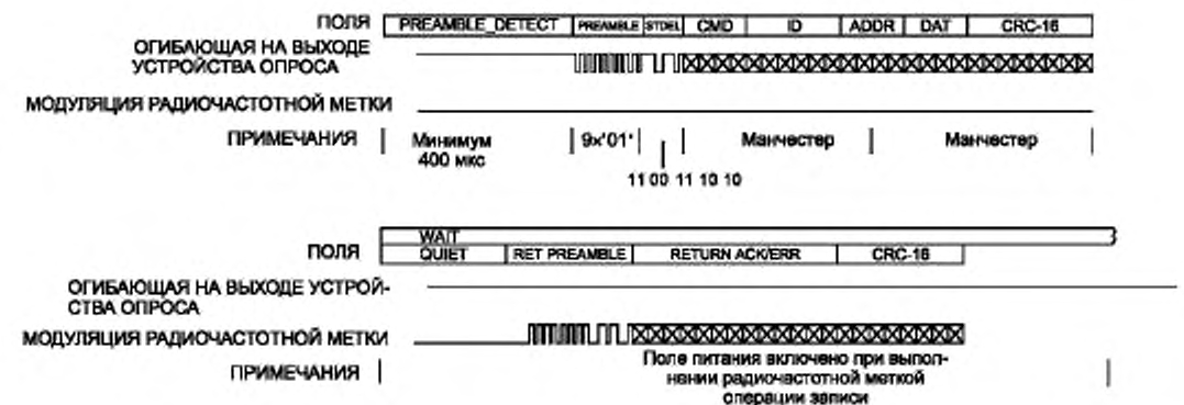
Рисунок 13 — Пример пакетов команды WRITE и ответа на команду (при скорости передачи данных по прямой и обратной линиям связи 40 Кбит/с)
