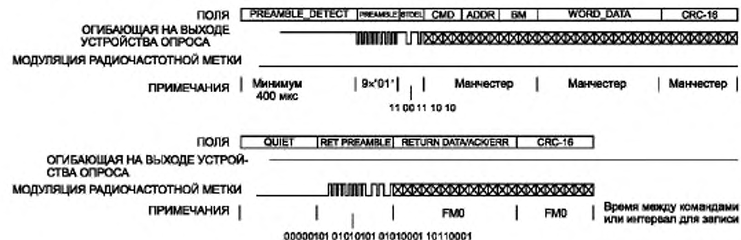
Рисунок 12 — Пример пакетов команды GROUP_SELECT и ответа на команду (при скорости передачи данных по прямой и обратной линиям связи 40 Кбит/с)
