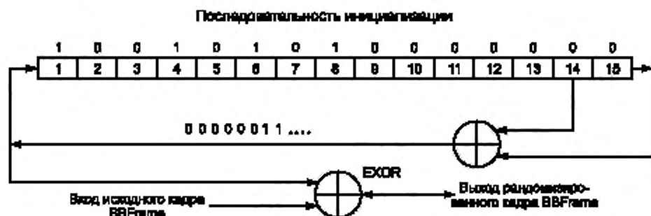
Рисунок 13 — Структурная схема возможной реализации кодера псевдослучайной последовательности
