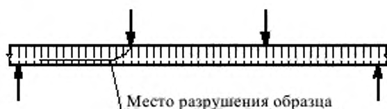
Рисунок В.5 – Типичная схема разрушения сердцевины от сдвига
