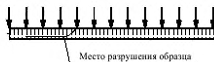
Рисунок Б.7 – Типичная схема разрушения сердцевины от сдвига
