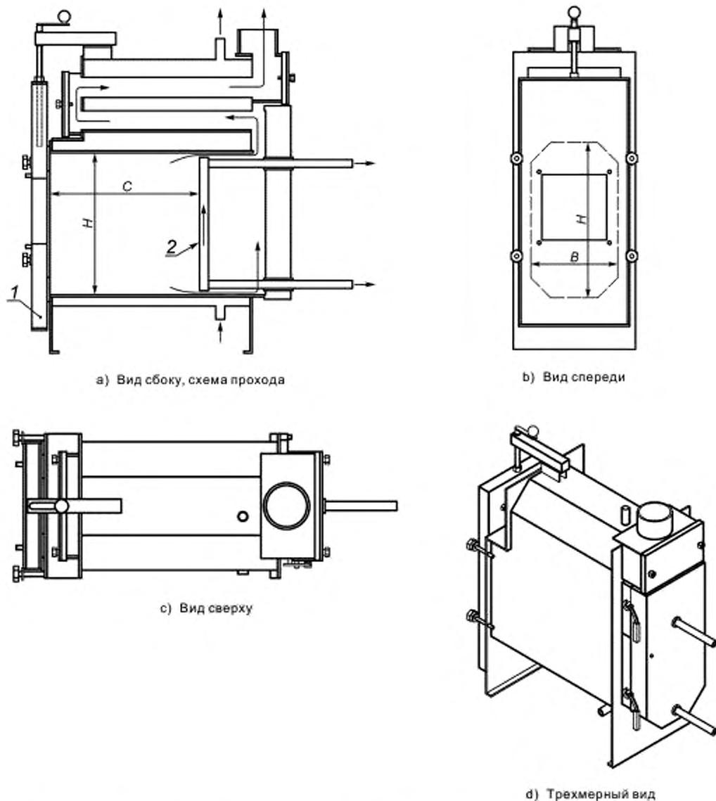
Минимальное расстояние между топкой горелки и верхней стенкой камеры сгорания должны быть указаны изготовителем.
