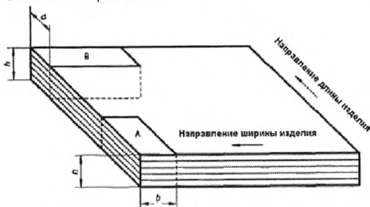
Рисунок 3 — Расположение образцов для испытания
