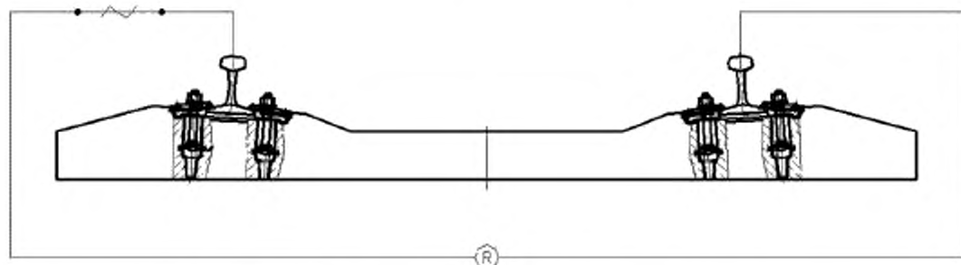
Рисунок 6 – Схема измерения электрического сопротивления
