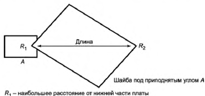
Рисунок 9 — Схема проведения измерения скручивания
