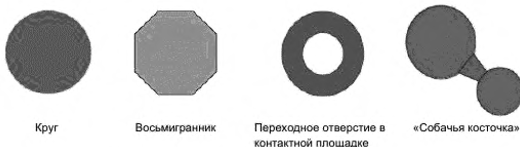
Рисунок 1 – Формы контактных площадок матричных посадочных мест
