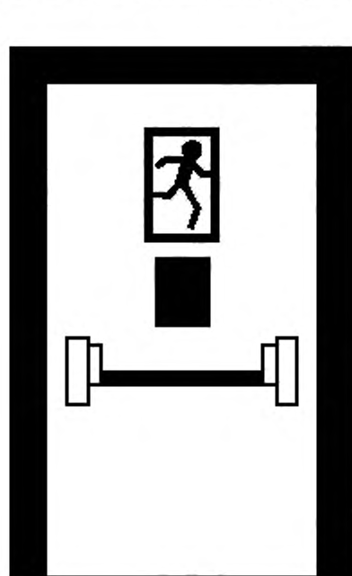
Рисунок Б.3 – Пример механически управляемого устройства «Антипаника» для дверей аварийных выходов
