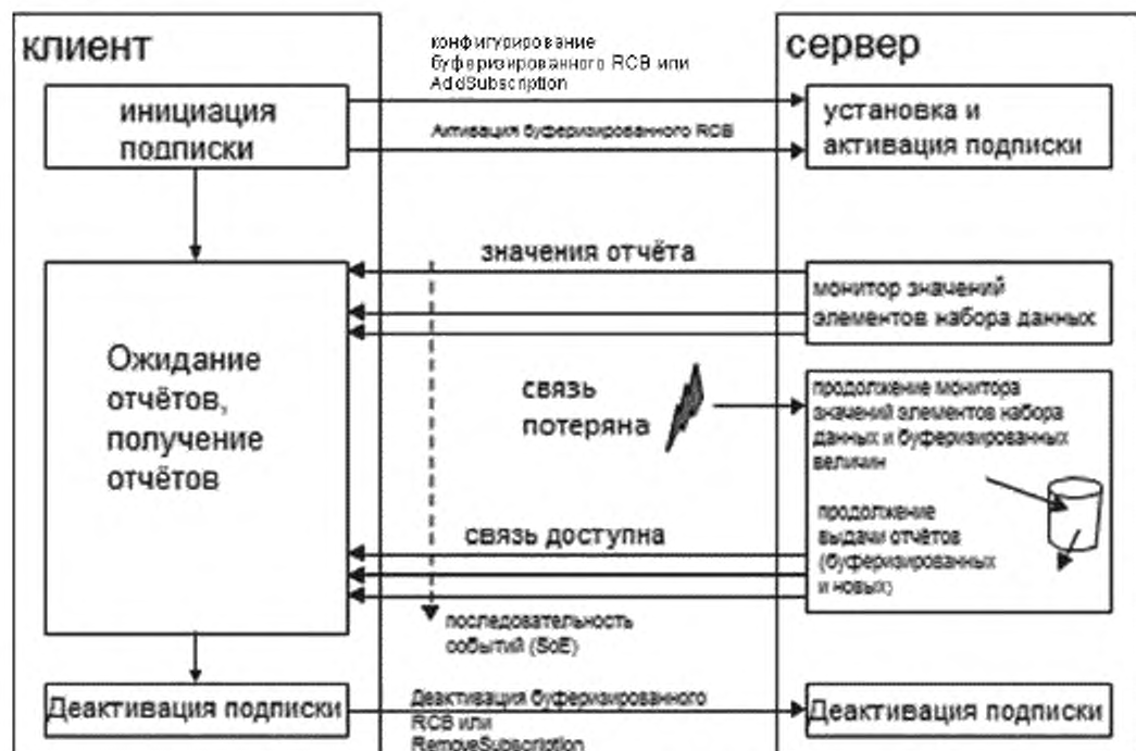
Рисунок 6 – Концепция блока управления буферизированным отчетом
