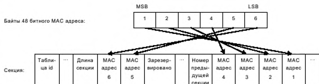
Р и с у н о к 4 — Отображение байтов MAC адреса в полях секции
