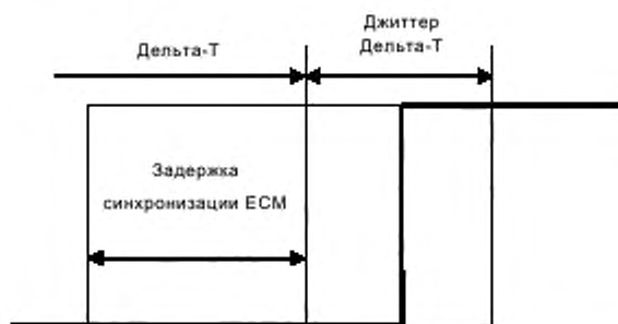
Рисунок 5 — Временная диаграмма джиттера Дельта-Т Figure 6:
