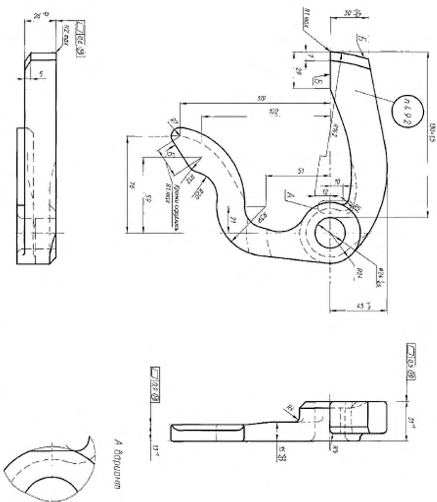
Рисунок Д.1 – Предохранитель замка (вариант 1)
