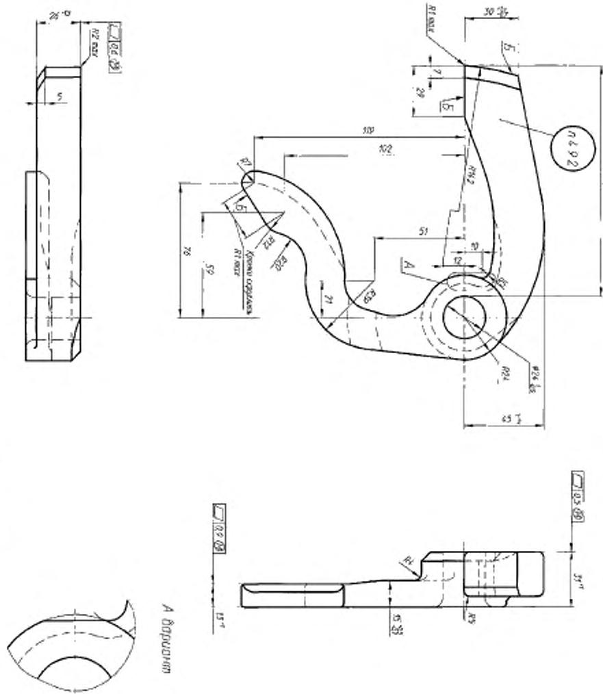
Рисунок Д.1 – Предохранитель замка (вариант 1)
