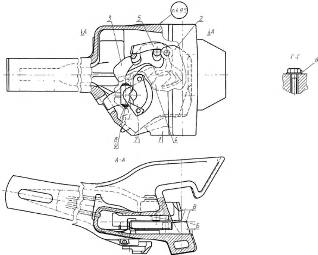
1 – корпус автосцепки; 2 – замок; 3 – замкодержатель; 4 – подъемник замка; 5 – предохранитель замка; 6 – шайба; 7 – валик подъемника; 8 – болт; 9 – гайка
