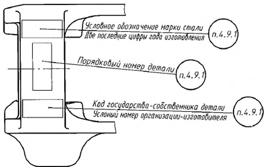
Рисунок И.3 – Расположение знаков маркировки
