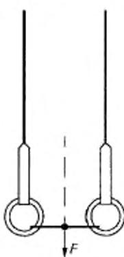
Рисунок 5 — Определение прочности закрепления гимнастических колец
