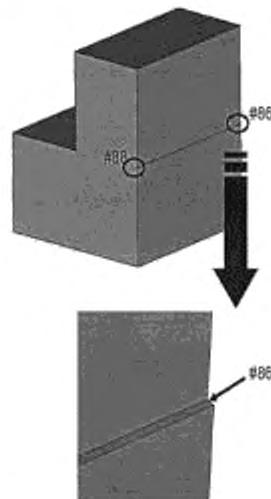
Рисунок D.2 — Типичный пример объекта **short\_length\_edge**
