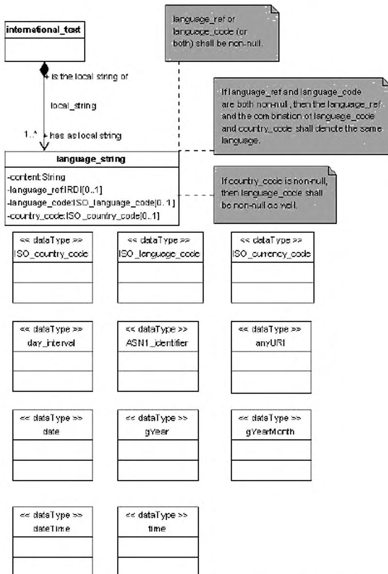
Рисунок 4 — Диаграмма класса UML для базовой модели данных
