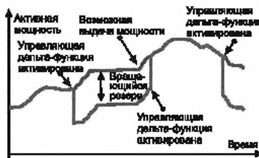
Рисунок В.4 – Схематическое изображение управляющей дельта-функции мощности
