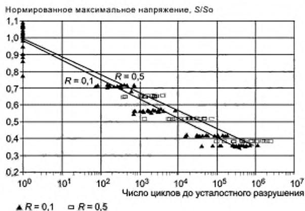
Рисунок Д.2 — Характерные усталостные кривые S - N для композиционного материала на основе стекловолокна
