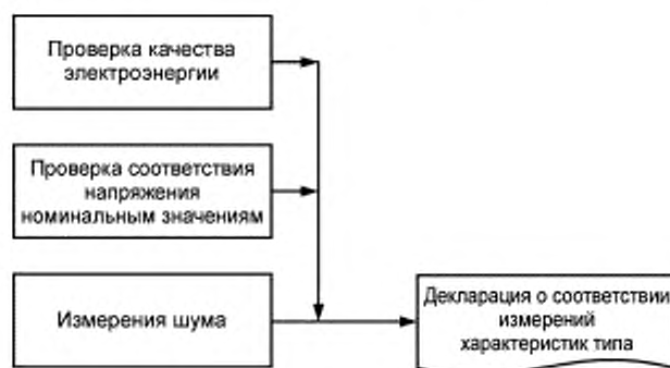
Рисунок 6 — Блок-схема элементов измерения характеристик типа
