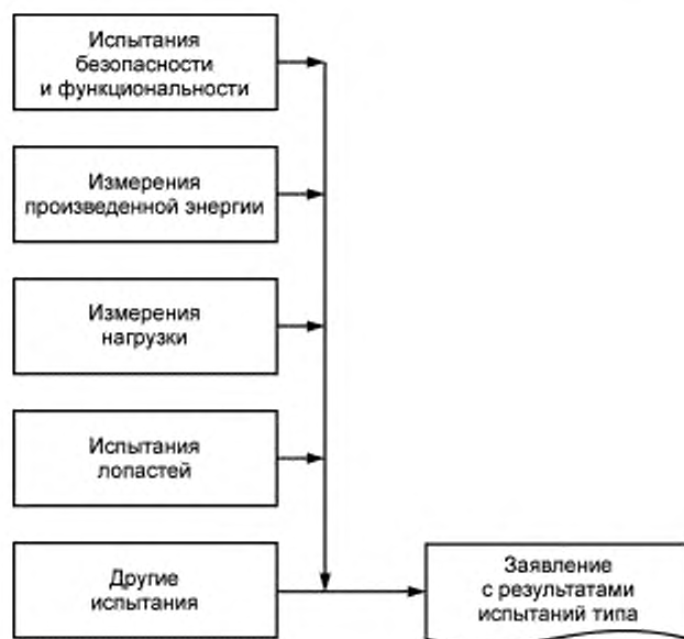
Рисунок 5 — Блок-схема процедуры типовых испытаний
