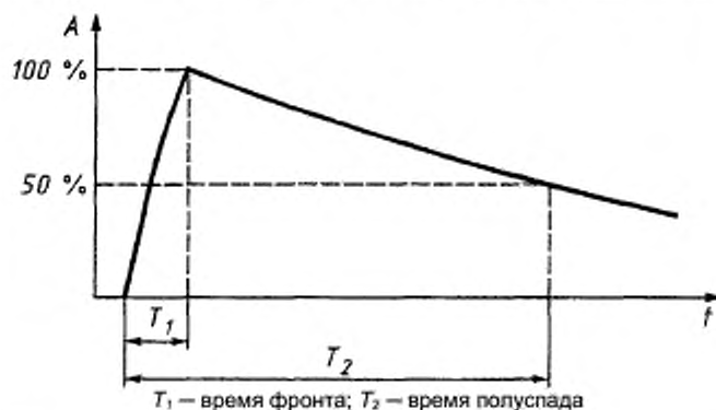
Рисунок Е.2 — Форма грозового импульса и импульса перенапряжения по линии связи
