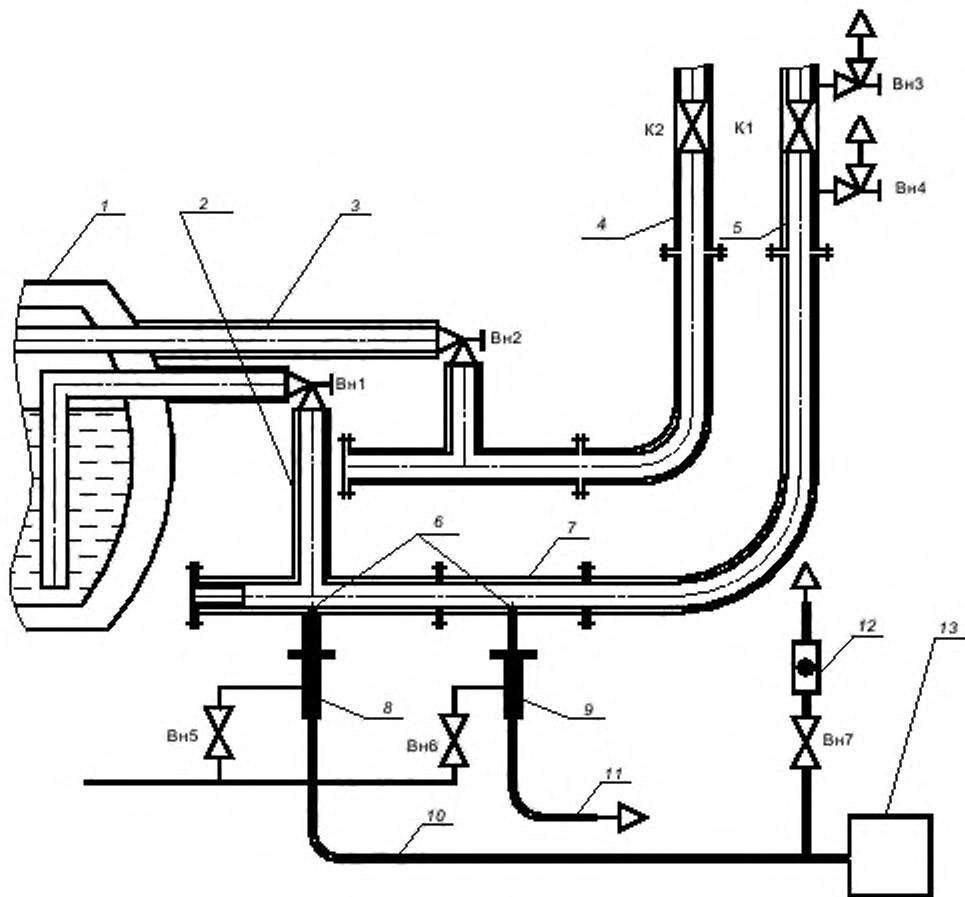
1 – Цистерна; 2 – трубопровод слива-налива; 3 – трубопровод газосброса; 4 – трубопровод газосброса станции наполнения (фронт слива); 5 – трубопровод слива-налива станции наполнения (фронт слива); 6 – капилляр; 7 – фильтр-проставка; 8 – пробоотборник на цистерне; 9 – пробоотборник на фильтре; 10, 11 – анализные линии; 12 – расходомер; 13 – аппаратура для анализа водорода; Вн – вентили ручные; К – клапаны с пневмоприводом.
