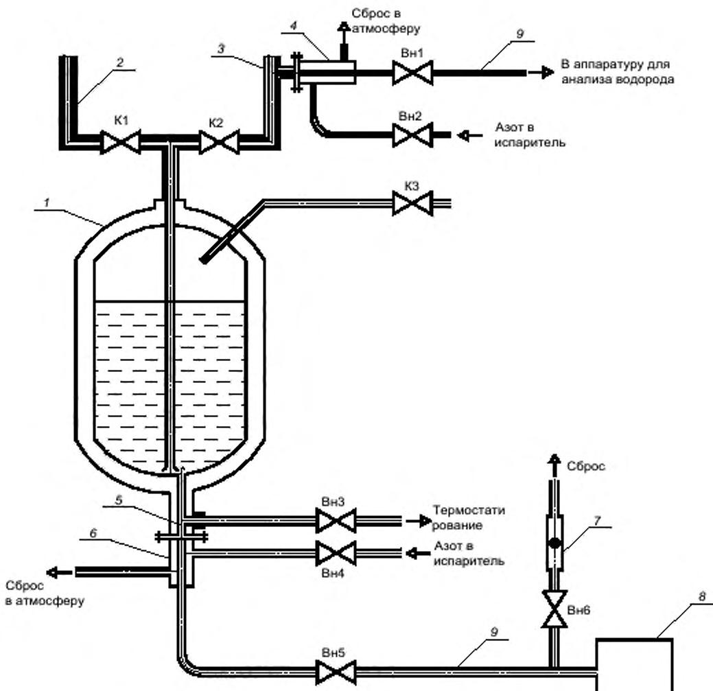
1 – Резервуар; 2 – трубопровод налива; 3 – трубопровод выдачи жидкого водорода; 4 – пробоотборник; 5 – трубопровод подачи жидкого водорода к пробоотборнику; 6 – пробоотборник; 7 – расходомер; 8 – аппаратура для анализа водорода; 9 – анализная линия; К1, К2, К3 – запорная арматура на трубопроводах залива, выдачи, дренажа; Вн – ручные вентили
