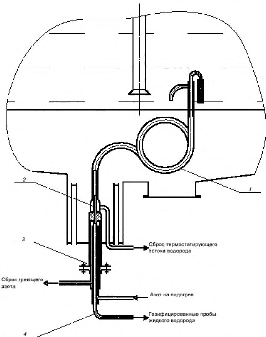
1 – термостатируемый пробоотборный трубопровод; 2 – капилляр (трубка 1x0,25 12-18Н10Т ГОСТ 14162); 3 – испаритель; 4 – анализная трубка
