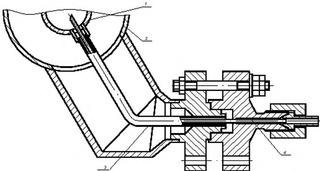
1 – трубопровод слива-налива цистерны; 2 – вакуумный кожух; 3 – трубопровод для установки капилляра; 4 – капилляр
