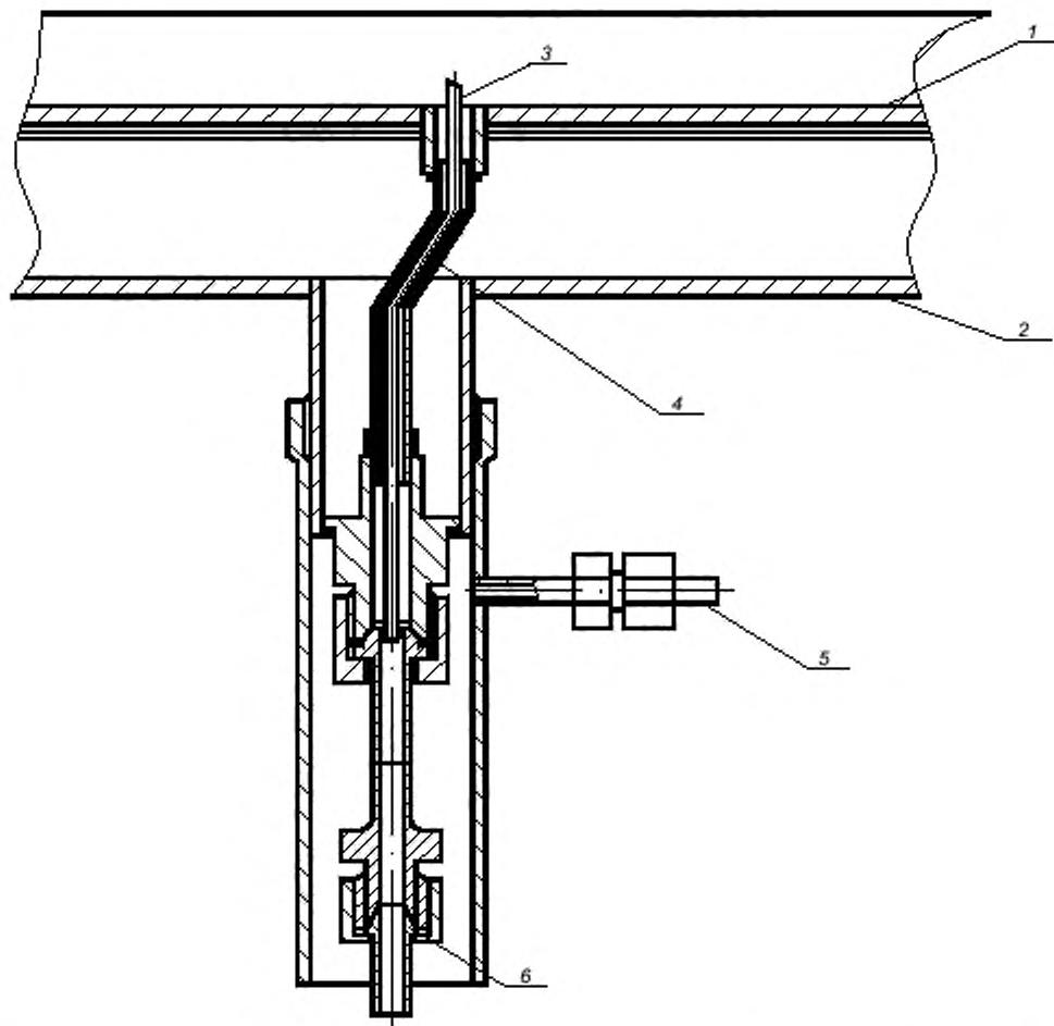
1 – внутренний трубопровод фильтра транспортной цистерны; 2 – вакуумный кожух; 3 – капилляр; 4 – трубопровод для установки капилляра; 5 – подвод греющего газа; 6 – ниппель
