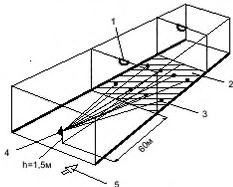
а – схема с фиксированным яркометром
