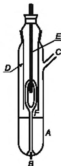
А — трубка, содержащая кипящую жидкость; В — платиновый провод, смонтированный в дно; С — боковая трубка; D — кожух; E — термометр; F — плечо насоса
