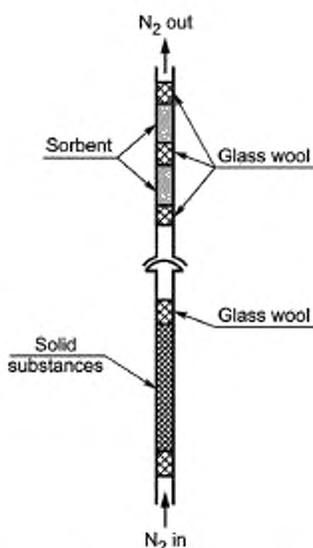
Рисунок 9 — Стеклянная трубка для твердых образцов
