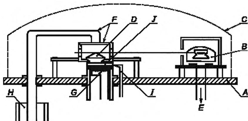
A — основание; B — вращающаяся катушка; C — вакуумный коппак; D — весы с чашками; E — устройство измерения вакуума; F — холодильная камера; G — печь — испаритель; H — сосуд Дьюара с жидким азотом; I — измерение температуры образца; J — тест-вещество
