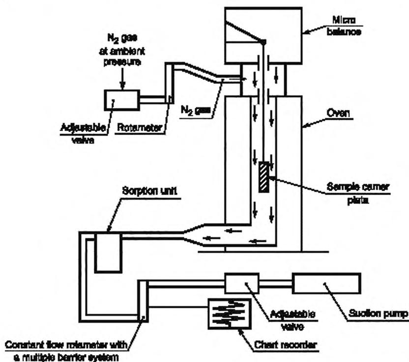
Рисунок 7 — Схема установки для эффузионного метода (изотермической гравиметрии)
