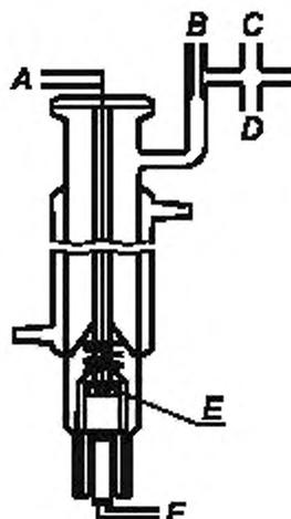
А — термопара; В — вакуумный буферный объем; С — датчик давления; D — соединение с вакуумом; E — точка измерения; F — электронного нагревательного элемента с.а. 150 Вт
