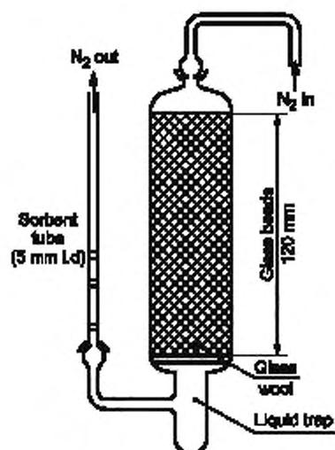
Рисунок 10 — Система держателя жидкого образца и сорбента
