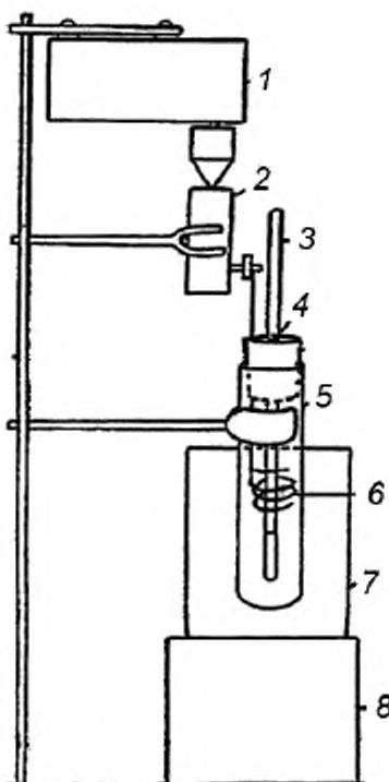
1 – вращающий электродвигатель; 2 – преобразователь вращательного движения в поршневое;
