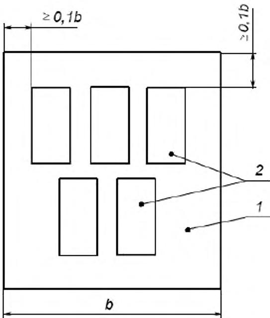
1 – пробы материала; 2 – образец материала;  $b$  – ширина пробы материала
