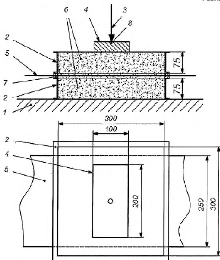
1 – массивное основание; 2 – испытательная форма; 3 – прикладываемая нагрузка; 4 – нагруженная плита;
