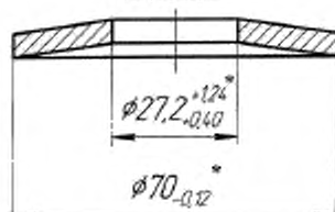
Рисунок 1 – Конструкция и размеры пружин
