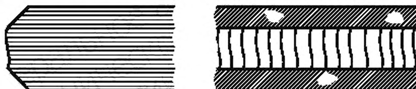
Рисунок А.1 — Притупленная кромка
